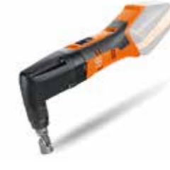
Akku-Knabber ABLK 18 1.6 E Select Bis zu 1,6 mm Materialstärke
