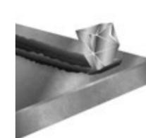
Konventionelles Korn ist unregelmäßig und hat eine eher blockige Form, die zu einer pflügenden Wirkung führt und beim Schleifen eine unerwünschte Wärme erzeugt.
