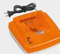
230 V. Für kürzere Ladezeiten der STIHL Akkus AK, AP und AR. Vorrichtung im Gehäuseboden zur Wandbefestigung und Kabelaufwicklung, mit Betriebszustandsanzeige (LED) und aktiver Akku-Kühlung.
