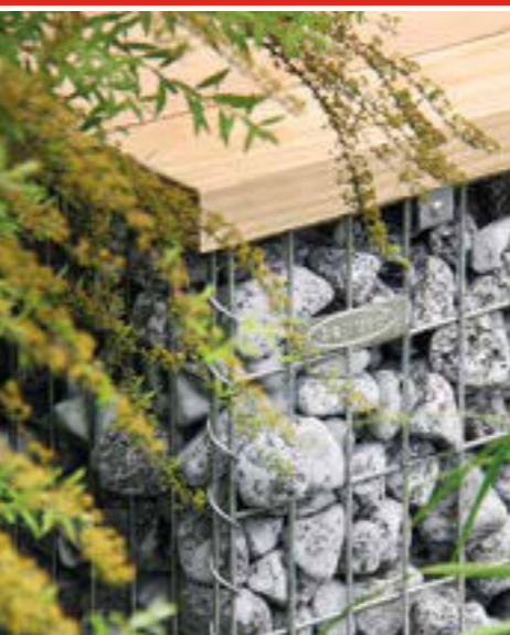
B. GABIONENBANK hochwertig, mit starker Holzauflage, in 3 Größen, Sitzfläche Douglasie 40 mm dick, Drahtstärke 4,5 mm, Material Alu-Zink, Maschenweite 10x5 cm
